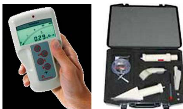
Thiết bị Radiagem-2000 Đo suất liều tia bức xạ Gamma, tia X; đánh giá nhiễm bẩn bề mặt bằng các phép đo tổng Alpha và Beta
